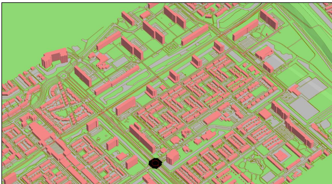
Afbeelding 1: 3D-impressie rekenmodel wegverkeerslawaai.
