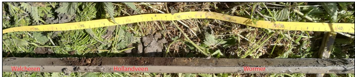
Figuur 10: De overgangen rond 6 m –mv in boring 12 van de afzettingen van het Laagpakket van Walcheren (kleilagen links op de foto), naar veen dat tot het Hollandveen Laagpakket behoort (midden) naar afzettingen van het Laagpakket van Wormer (kleilagen rechts).
