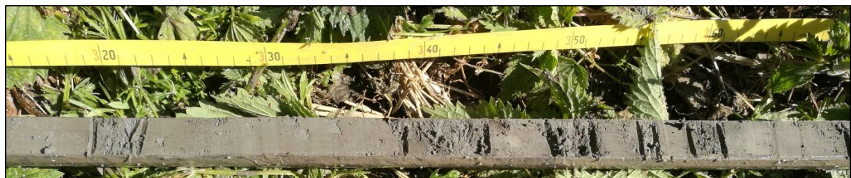
Figuur 12: Gelaagde afzettingen en een doorgaande sedimentatie zonder omwerking door bioturbatie in boring 12: klei- en zandlagen. De klei is ongerijpt. De foto toont het bereik van 3,15 tot 3,70 m –mv.
