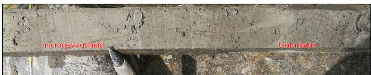
Figuur 11: De van links naar rechts en van boven naar beneden uitgelegde bovenste 2,2 m van boring 09. De foto is gemaakt rond 4,5 m –mv.
