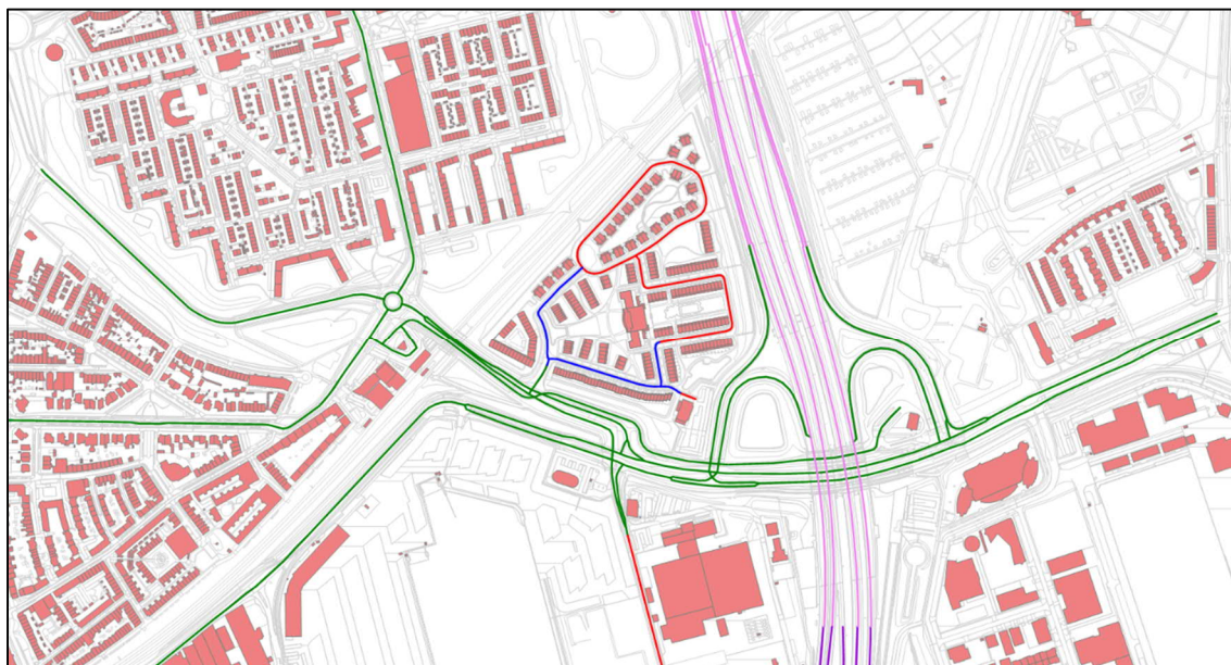
Afbeelding 19 Verhardingen: referentiewegdek (groen), elementenverharding in keperverband (rood), stille elementenverharding (blauw), 1laags zeer open asfaltbeton (paars) en 2laags zeer open asfaltbeton (roze)
