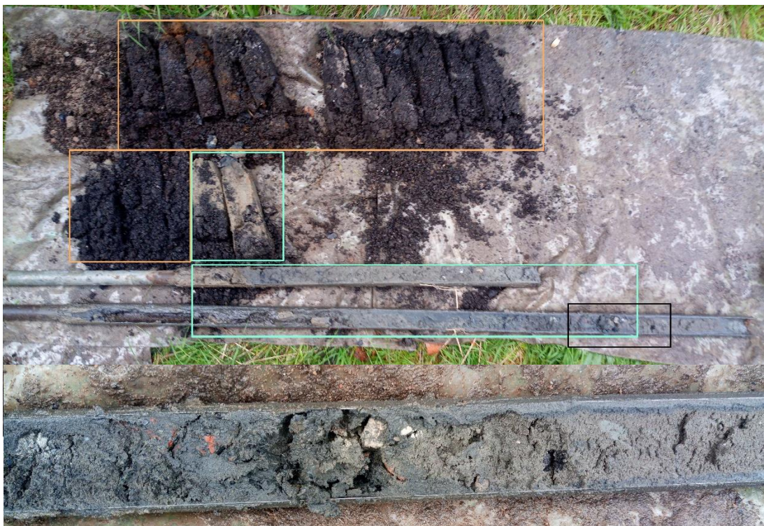
Boring 3. Boven: 0-300 cm -Mv. Het zwarte blok toont het traject weergegeven op de onderste foto. Onder: detail slootvulling met bouw materiaal.
