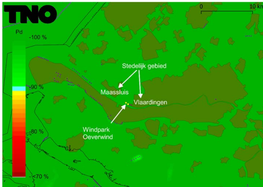
Figuur 6 Detectiekans van het primaire verkeersleidingsradarnetwerk op 1000 voet boven het bouwplan nadat deze is gerealiseerd. De locatie van de nieuwe windturbines is aangegeven met gele stippen.
