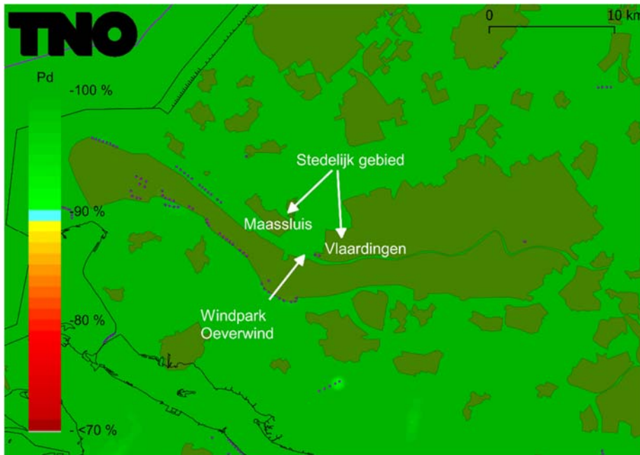
Figuur 5 Detectiekans van het primaire verkeersleidingsradarnetwerk op 1000 voet boven het bouwplan voordat dit is gerealiseerd (baseline).
