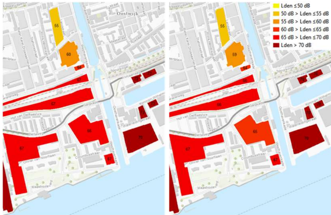
Figuur 4.1 Gesommeerde geluidbelasting plansituatie (links) en na toepassing van walstroom (rechts)
