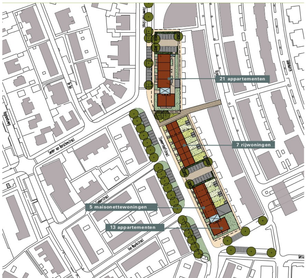
Figuur 2: Ontwerptekening van het plangebied. De twee blauw-grijze vlakken tussen de bruine bouwvlakken zijn de locaties van de liften.
