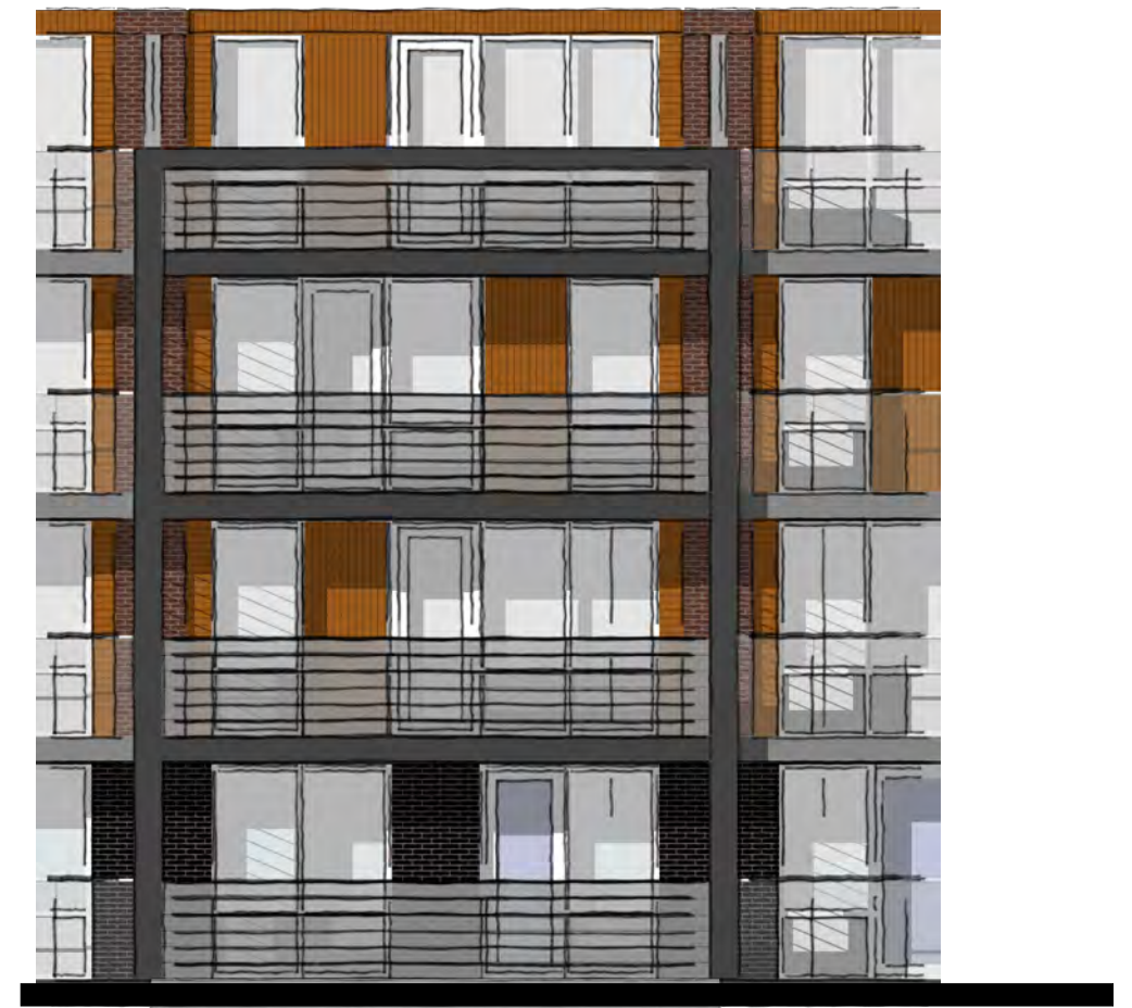
Fragment Zuidgevel tpv 65 m2 appartementen (schaal 1 op 100)
