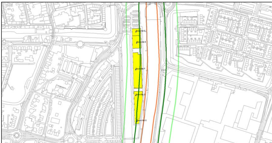
Figuur 23 Geluidscontouren scheepvaart Merwedekanaal ter hoogte van bouwvlak E, F en G (licht groen - 43 dB(A), donker groen - 48 dB(A) en oranje - 53 dB(A))
