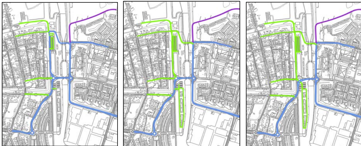
Figuur 9: Maximumsnelheden 2019 en 2030 bestaande wegligging en 2030 aangepaste wegligging (groen - 30 km/uur, blauw - 50 km/uur en paars - 60 km/uur)
