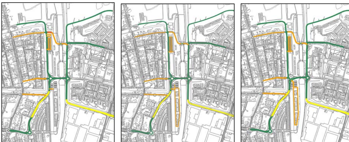
Figuur 10: Verhardingen 2019 en 2030 bestaande wegligging en 2030 aangepaste wegligging (groen - referentiewegdek, oranje - klinkers in keperverband, rood - klinkers, niet in keperverband en geel - dunne deklaag type A)
