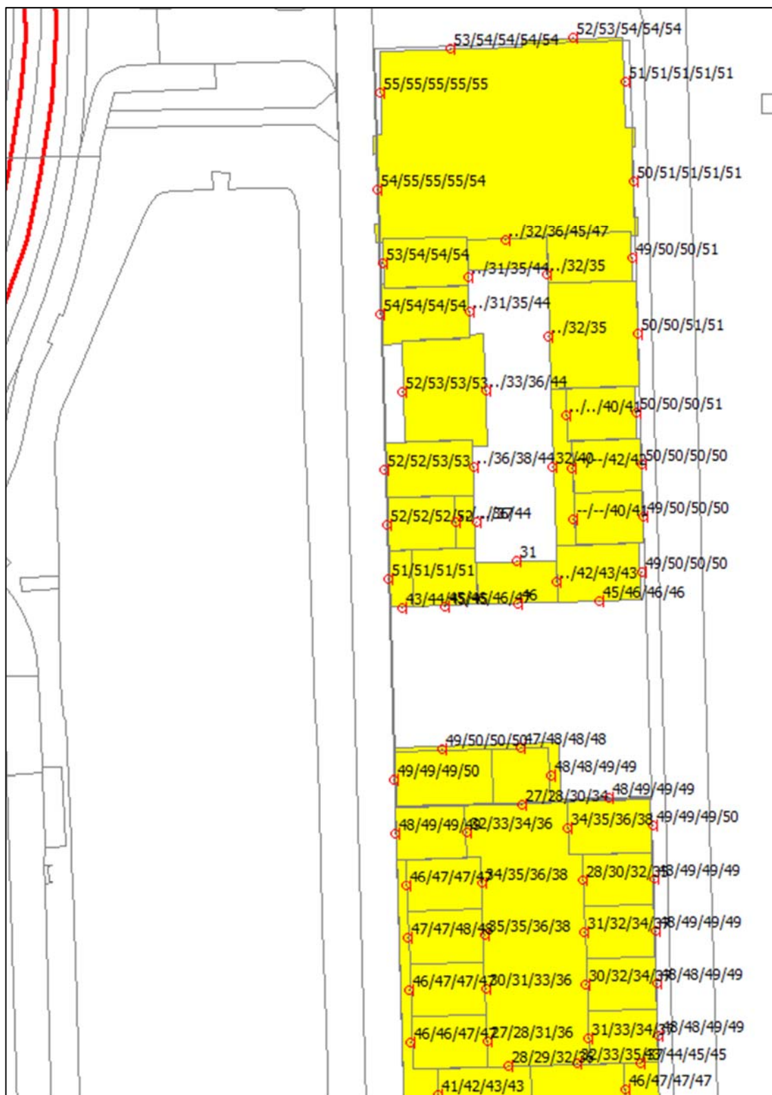
Figuur 16 Geluidsbelasting 2030 t.g.v. verkeer op Aimé Bonnastraat - Hagenweg (bestaande wegligging) – bouwvlak E en F
