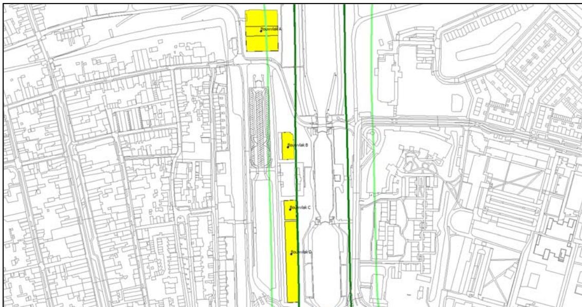
Figuur 22 Geluidscontouren scheepvaart Merwedekanaal ter hoogte van bouwvlak A t/m D (licht groen - 43 dB(A) en donker groen - 48 dB(A))
