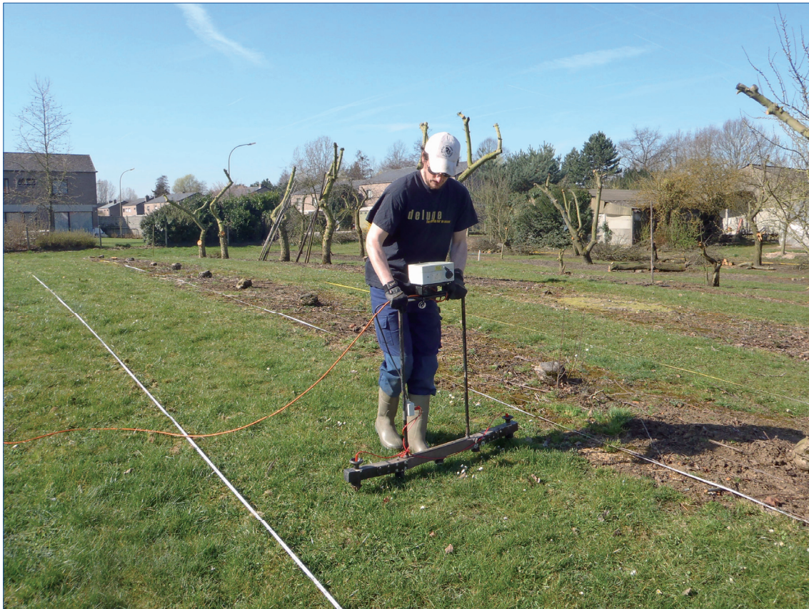
Figuur 2. Impressie van een elektrisch weerstandsonderzoek.
