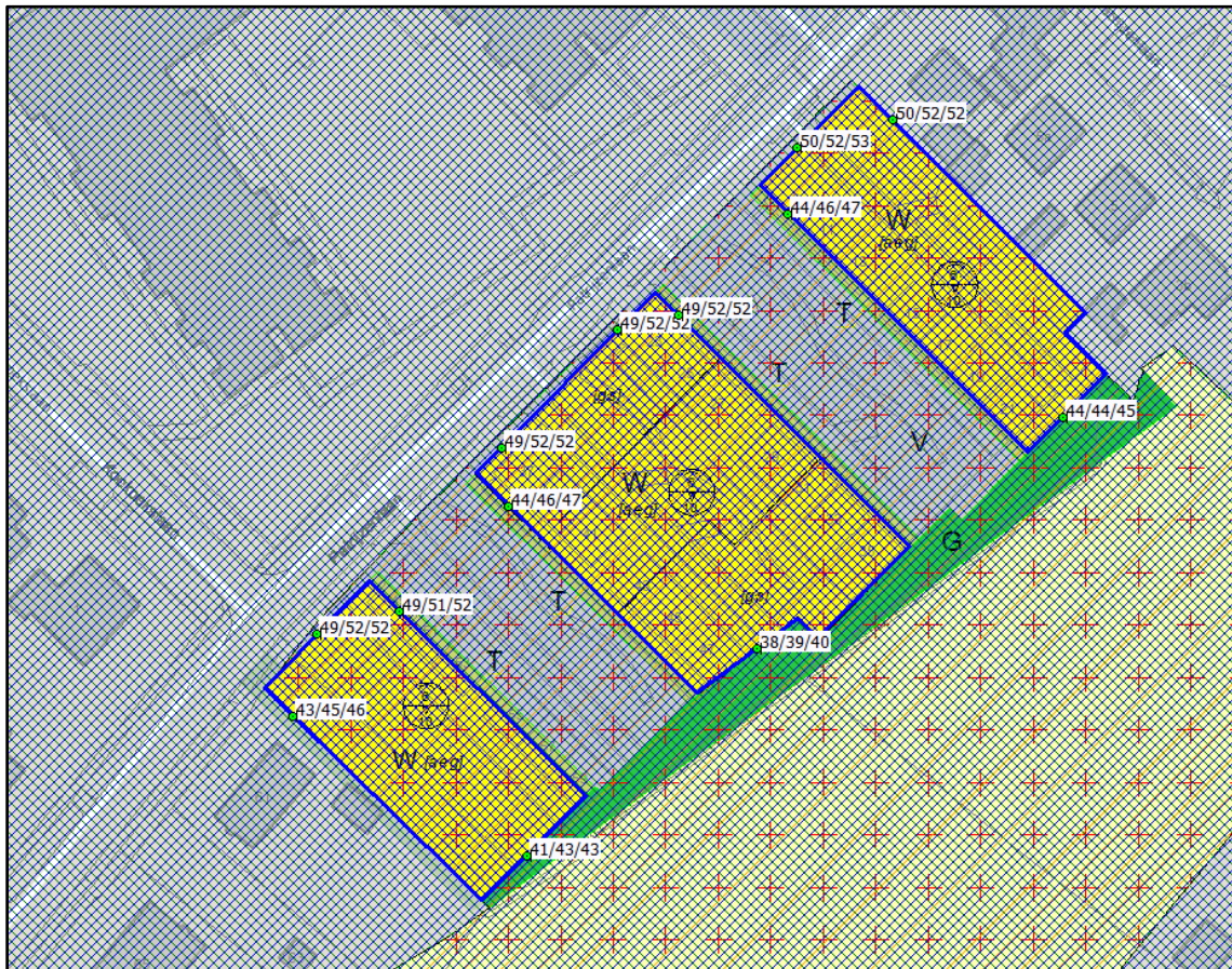
Figuur 4.6 Geluidbelasting Maasvlakte-Europoort per bouwvlak
