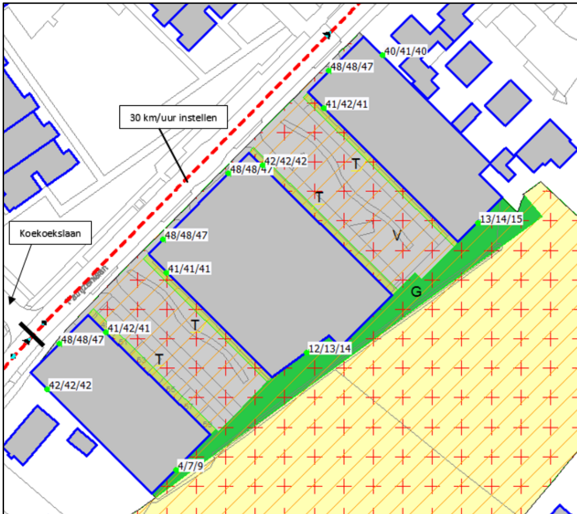
Figuur 4.3 Geluidbelasting Patrijzenlaan na instellen 30 km/uur ten oosten Koekoekslaan
