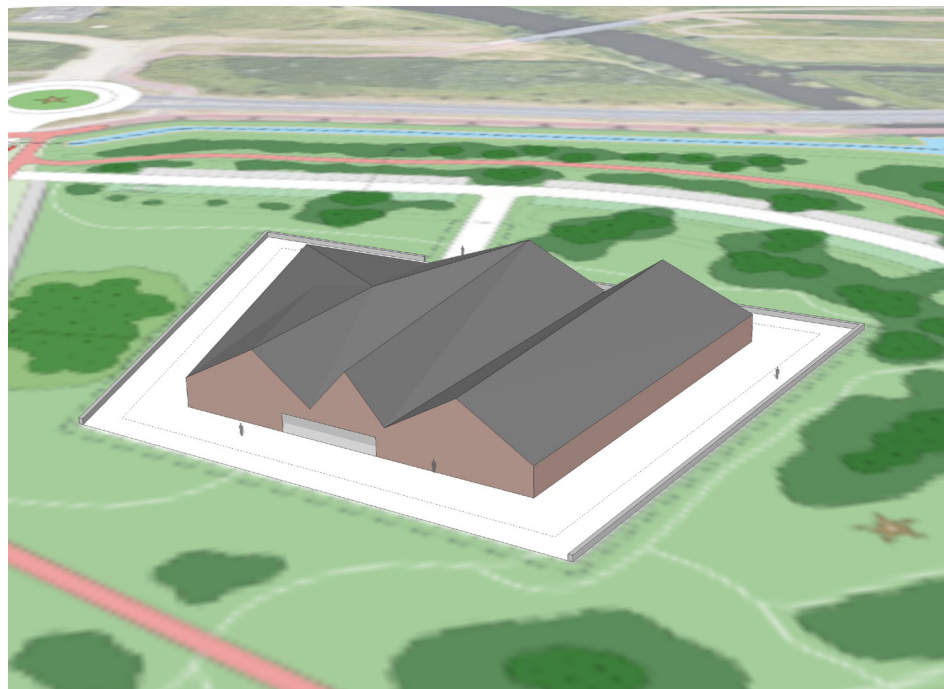
Proefverkaveling erf 3, model 3, groot aaneengesloten volume, maximale bebouwing, bebouwingspercentage bouwvlak is 70%
