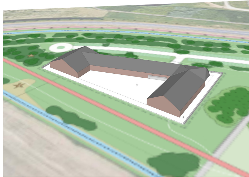
Proefverkaveling erf 2, model 2, aaneengesloten volume met centrale open ruimte, bebouwingspercentage bouwvlak is 70%
