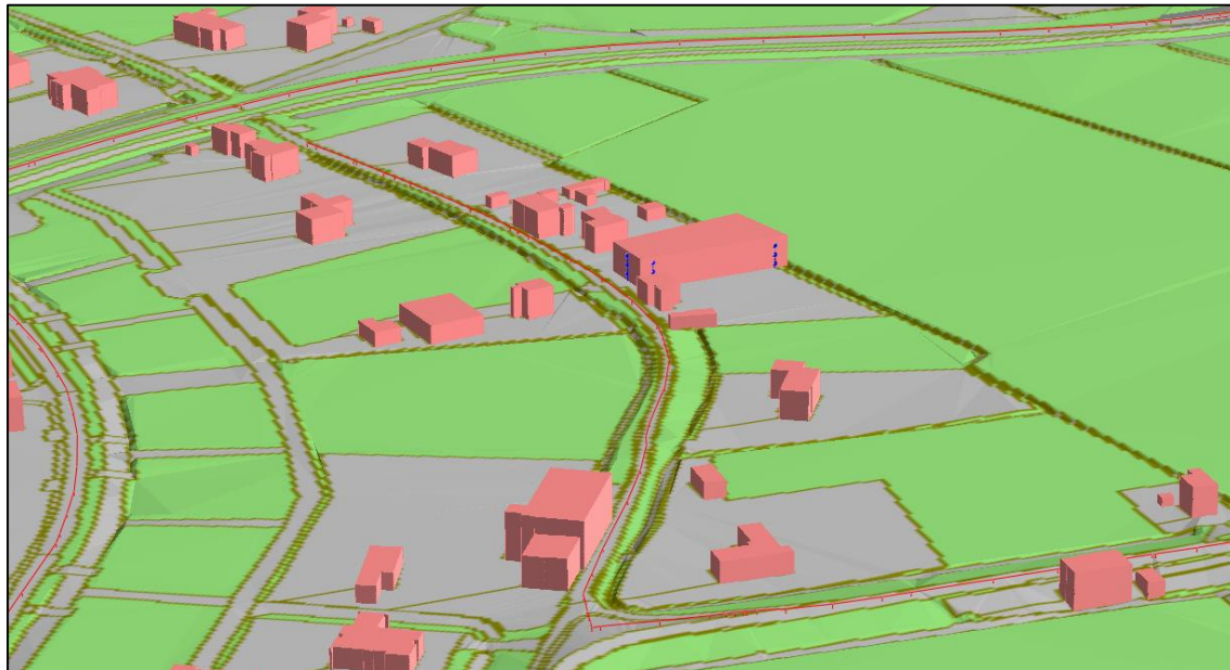
Figuur 4.1: 3D-weergave akoestisch rekenmodel wegverkeerslawaaï
