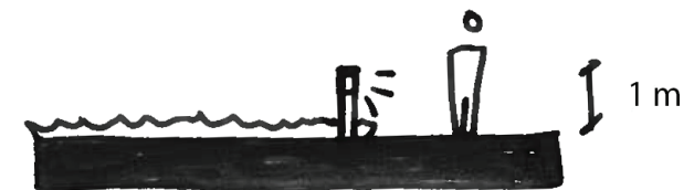
Verlichting parkpad Lage lichtmast van circa 1m hoog. Schijnt gericht op het parkpad en minimaliseert lichtverstrooiing in het park.
