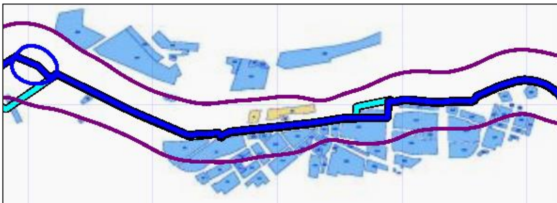
Afbeelding 6: Plaatsgebonden risico voor de gasleiding A-559.
