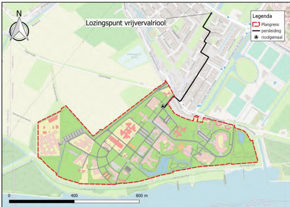
Afbeelding 3-7: Bestaand gemaal en persleiding
