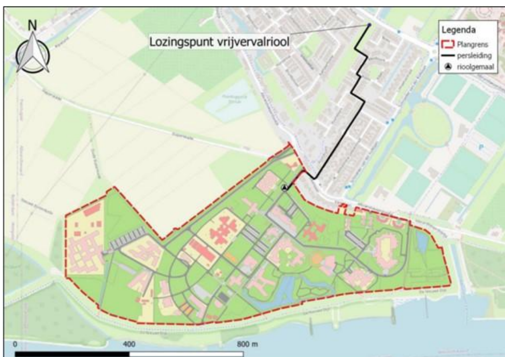
Figuur 36: Bestaand gemaal en persleiding (bron: Waterfeit adviseurs)
