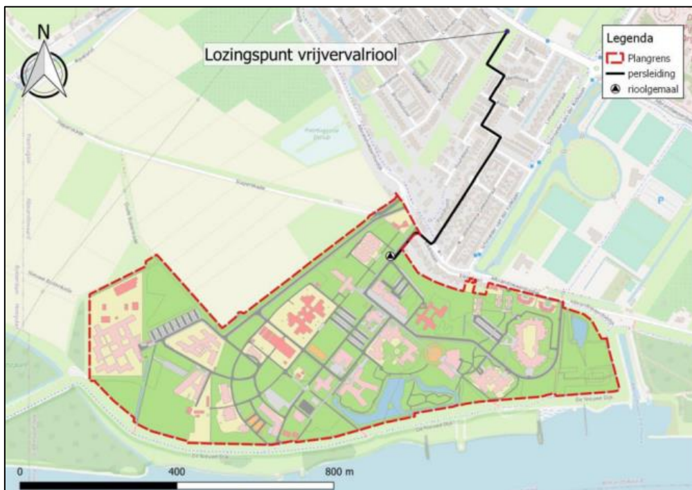
Figuur 33: Bestaand gemaal en persleiding (bron: Waterfeit adviseurs)
