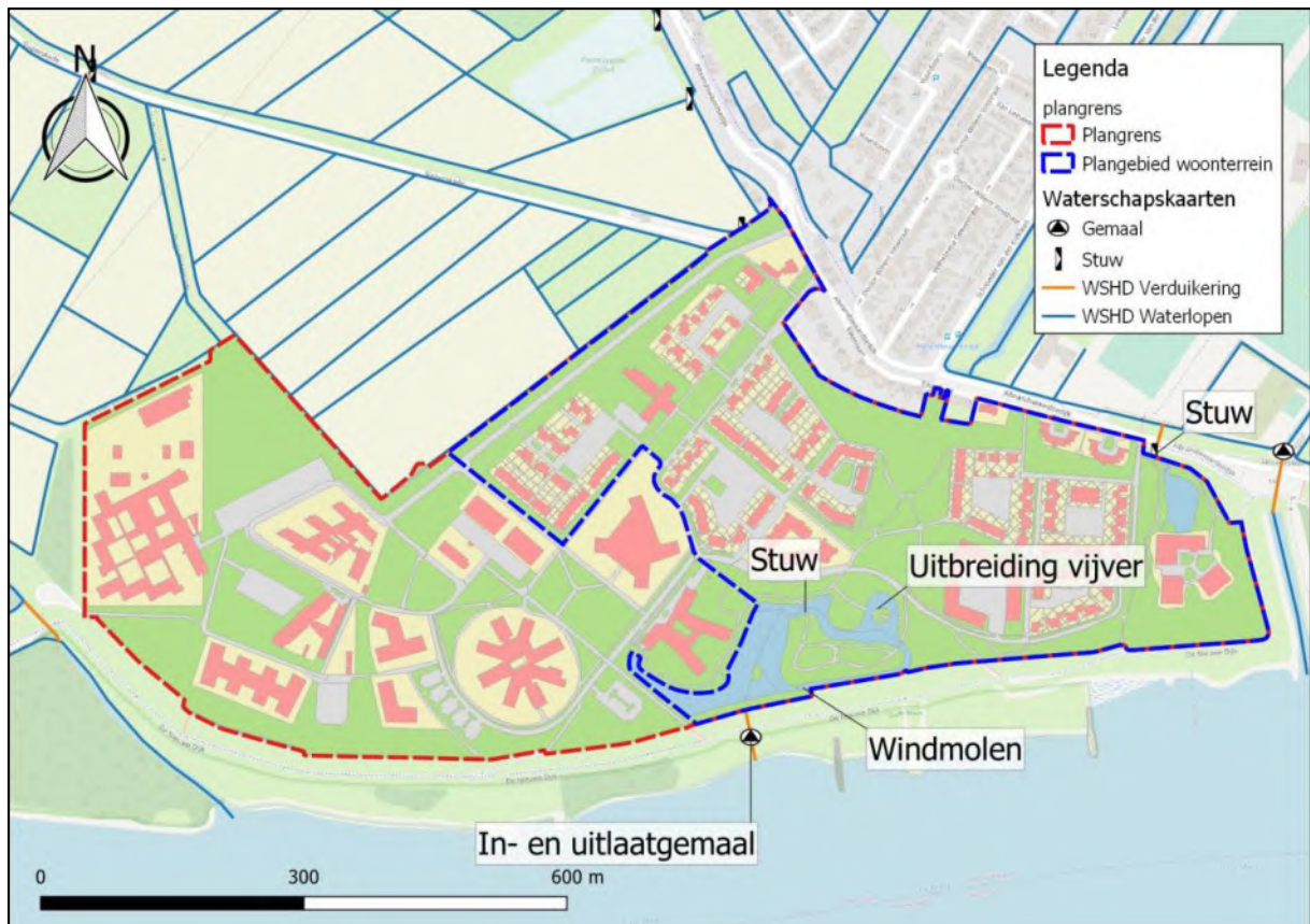
Afbeelding 4-1: Watersysteem toekomstige situatie
