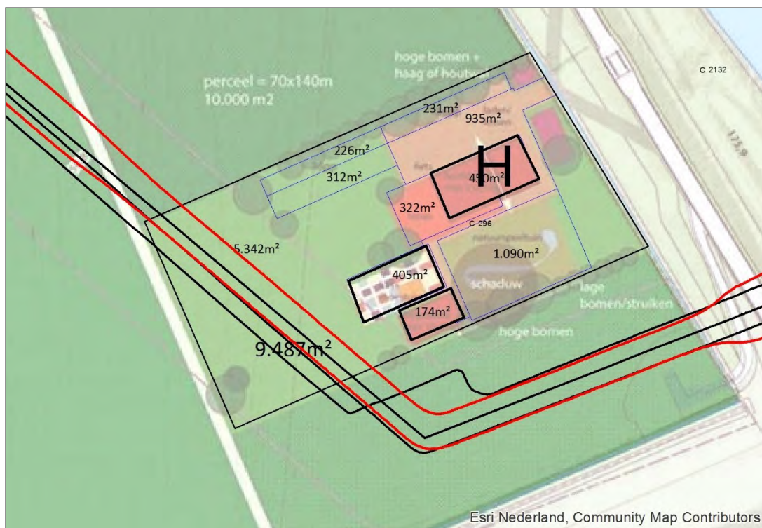
Figuur 11. Plaatsgebonden risicocontour 10^{-6} waterstofleiding over plangebied
