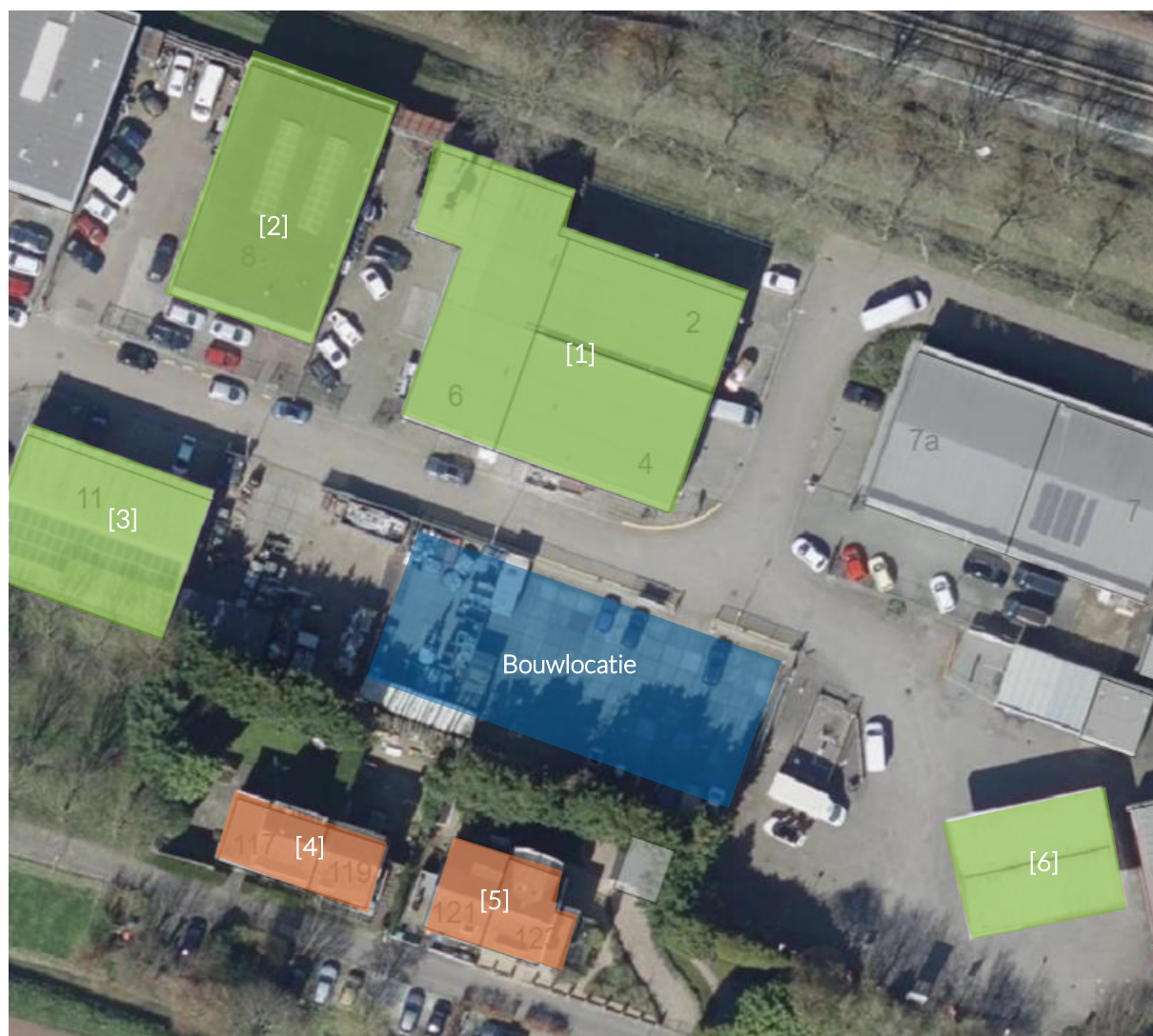
FIGUUR 5: RISICOKAART TRILLINGEN PREFAB BETONPALEN OP BASIS VAN EEN INDICATIEVE METING, ROOD: OVERSCHRIJDINGEN, ORANJE: INCIDENTEEL OVERSCHRIJDINGEN SBR-A, GROEN: GEEN OVERSCHRIJDINGEN SBR-A
