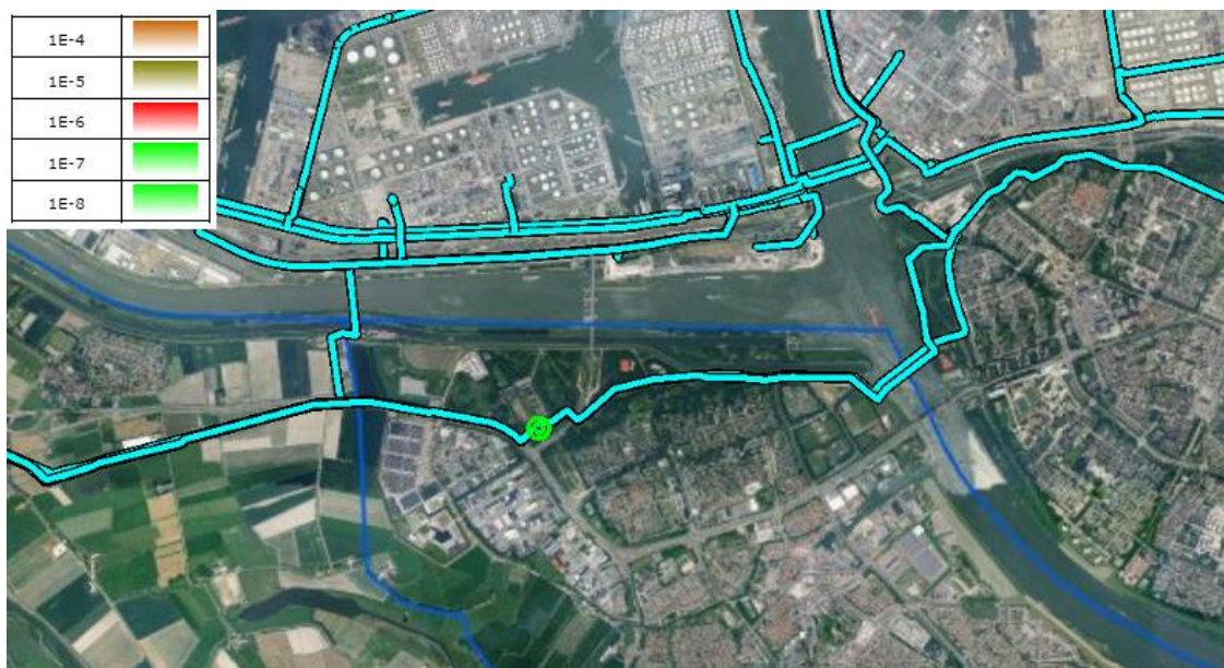
figuur 6: plaatsgebonden risico buisleiding A-537-01
