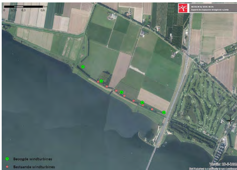
Figuur 1 - Layout beoogde en bestaande windpark
