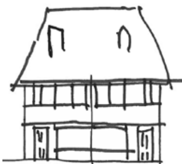
Een klassieke gevelopbouw van basis, tussendeel en kap versterkt de horizontale geleding van grondgebonden woningen
