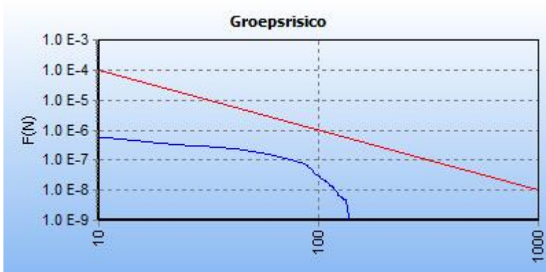
5.2 Figuur 5.6 FN curve voor 2131_leiding-W-524-01-deel-1 van N.V. Nederlandse Gasunie voor de kilometer tussen stationing 3900.00 en stationing 4900.00
