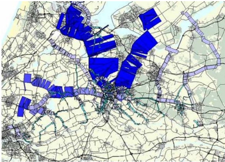
Afbeelding 5: Kaart uitstroomprofiel van de evacuatiecalculator. Geeft aan hoe postcodegebieden naar 'uitgangen' worden geleidt. Hoe groter de blauwe vlek, hoe groter de verkeersbelasting op de onderliggende weg. Hieruit blijkt dat die op de N210 laag is.
