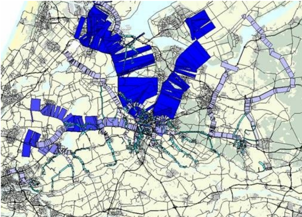
Afbeelding 7: Kaart uitstrooprofiel van de evacuatiecalculator. Geeft aan hoe postcodegebieden naar 'uitgangen' worden geleid. Hoe groter de blauwe vlek, hoe groter de verkeersbelasting op de onderliggende weg. Hieruit blijkt dat die op de N210 laag is.
