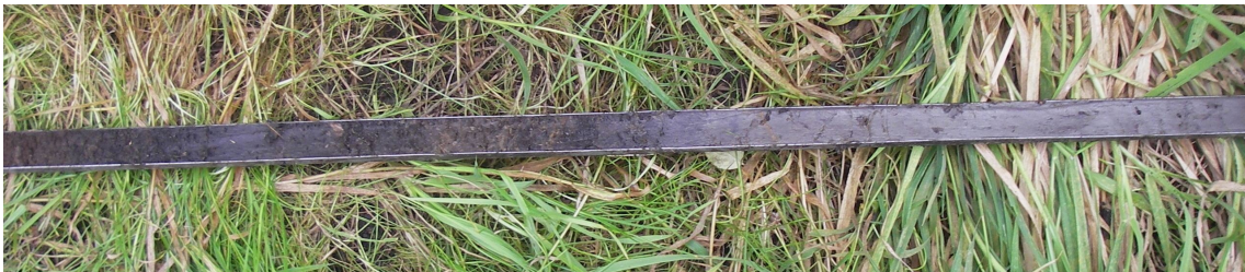
Figuur 7. Schoonhoven, Mr. Kesperstraat. De overgang van veen (links) naar klei (rechts) zoals deze onderin de boringen (in dit geval in boring 1) is aangetroffen.
