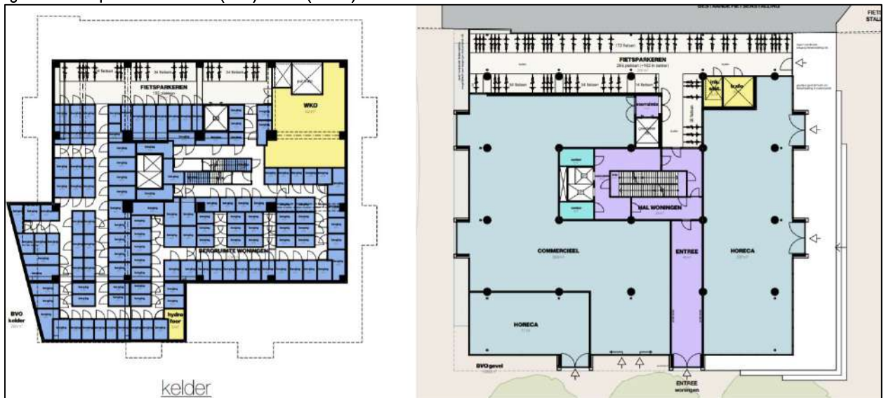
figuur 18. Fietsparkeren in kelder (links) en BG (rechts)
