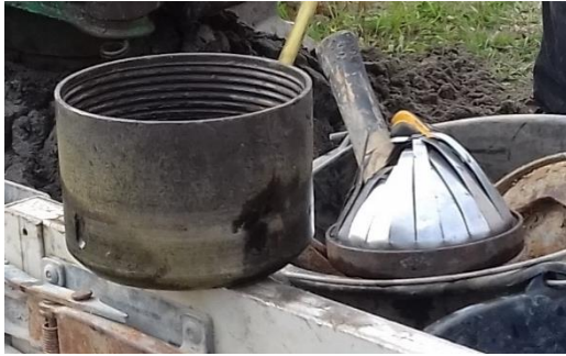
Figuur 6: Boorkop (links) wordt onder de boorstang geschroefd en Catcher (rechts) die zit tussen de boorkop en de PVC-buis.
