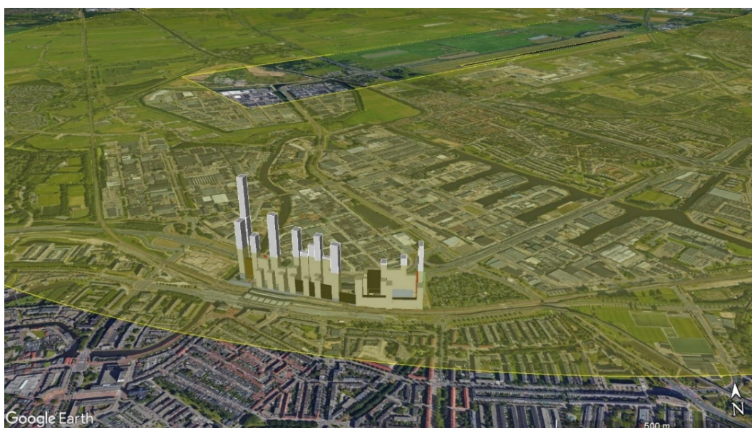
Figuur 7.2: Beoogde bebouwing in de nabijheid van Rotterdam-The Hague Airport doorsnijding met de IHS
