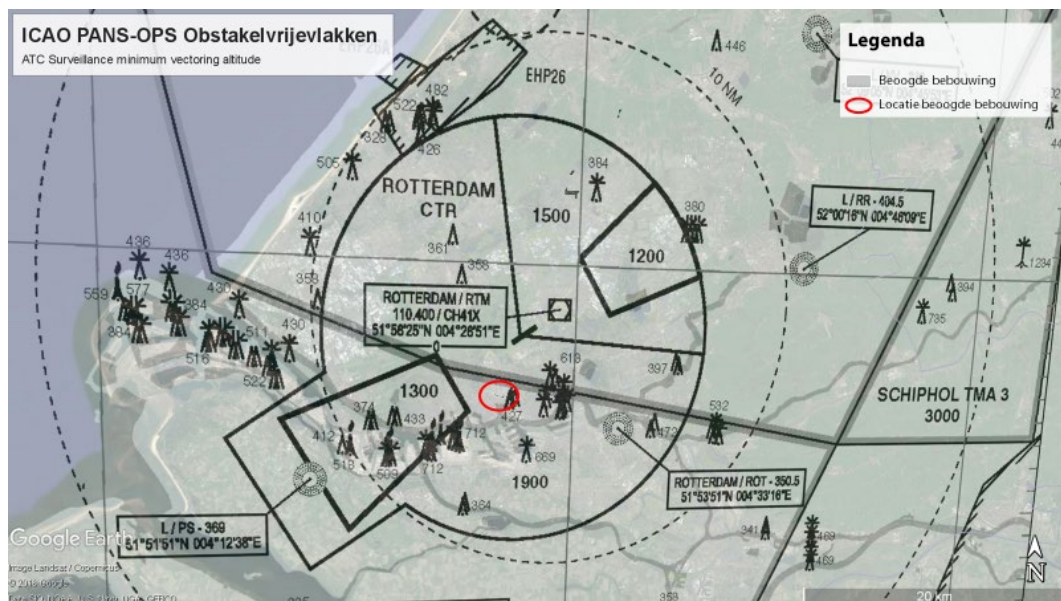
Figuur 7.32: Overzicht MVA en beoogde bebouwing
