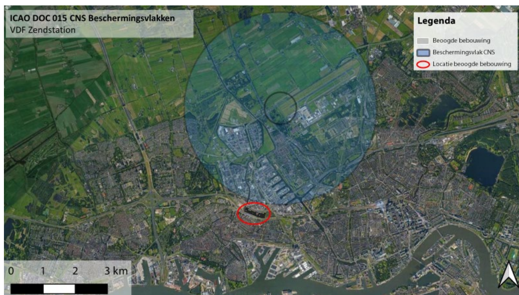
Figuur 7.48 Rotterdam-The Hague VDF Beschermingsvlak overzicht
