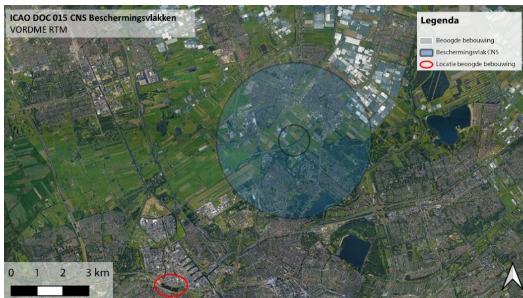
Figuur 7.47: Rotterdam-The Hague VORDME Beschermingsvlak overzicht
