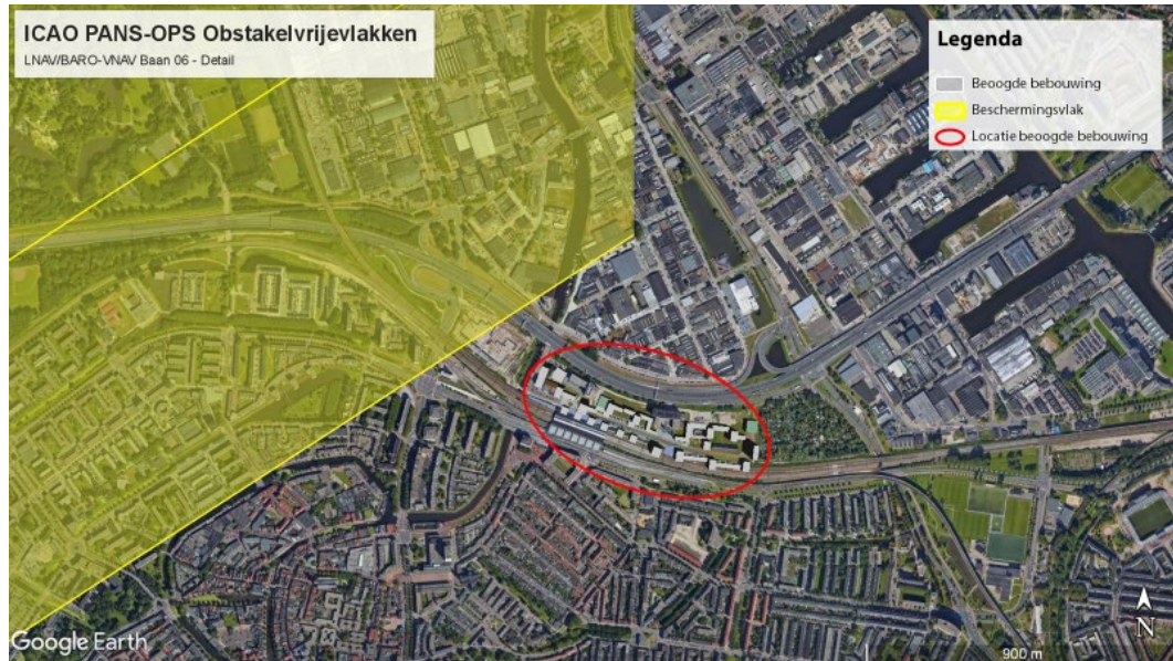
Figuur 7.15: RNP RWY06 LNAV-VNAV – Detail weergave
