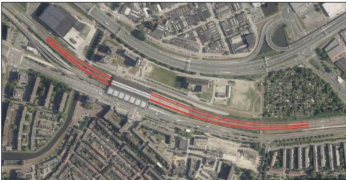
Afbeelding 114 Sporen (rood) met raildempers
