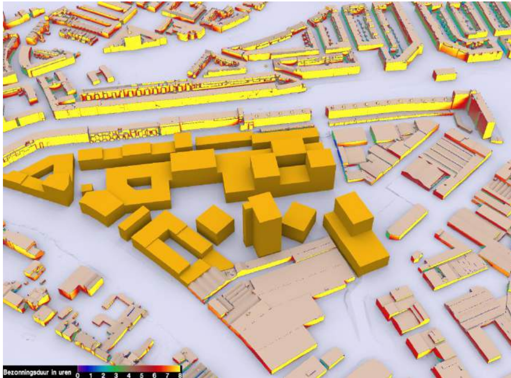
f 3.1 Mogelijke bezonningsduur op de bestaande omgevingsbebouwing van het plan op 21 september op een schaal van 0 tot 8 uur
