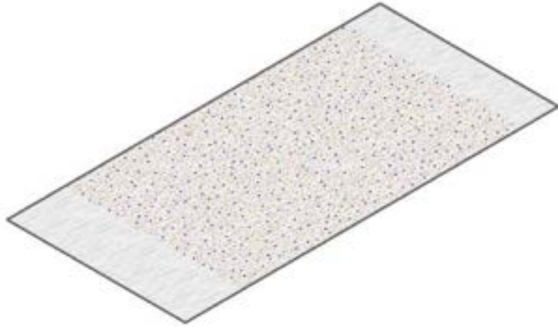
1A. In situ gestort beton met gerecycleerde glazen granulaten
