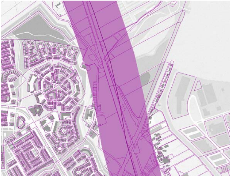
Ondergrondse buisleiding onder hoge druk met vrijwaringszone en invloedsgebied
