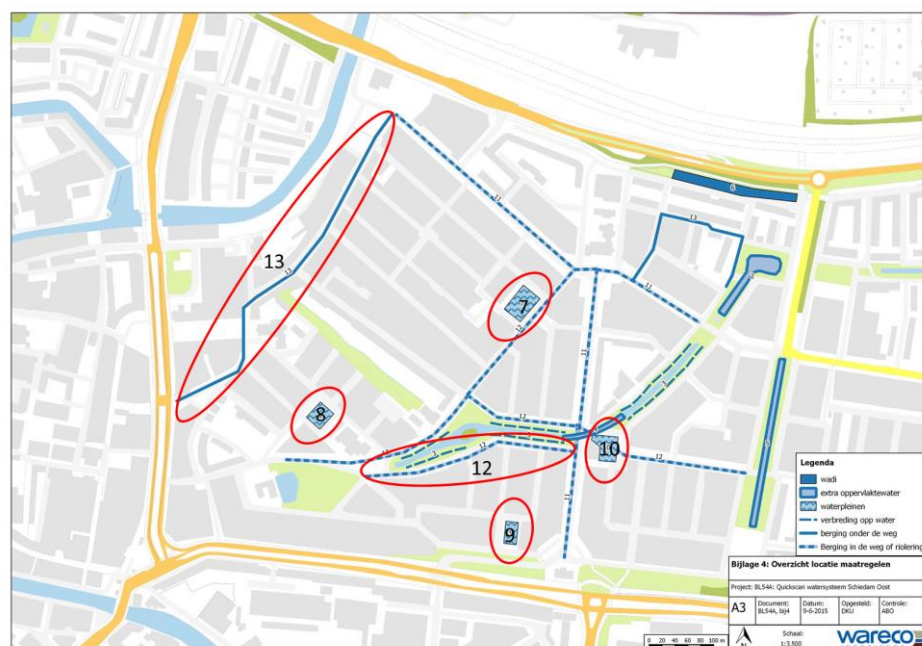
Figuur 4-11 De rood-omcirkelde gebieden zijn de theoretische locaties waar berging van de gemengde riolering wordt gecreëerd
