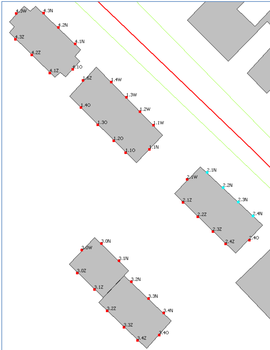
Figuur 6: in blauw de beoordelingsposities met een overschrijding voorkeursgrenswaarde t.g.v. het wegverkeer op de Vrijenbanselaan in situatie 02a
