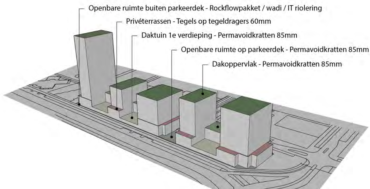
Afbeelding 7; Conceptuele weergave van de verschillende typen waterberging
