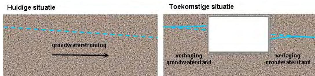
Figuur 1.1 Schematische weergave van barrièrewerking op grondwaterstroming
