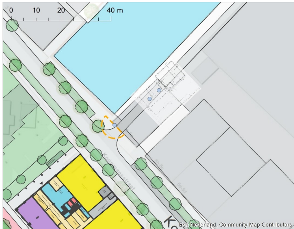
Figuur 7. Contour 10 \text{ kW/m}^2 (oranje stippellijn) vanaf de deur aan de voorzijde
