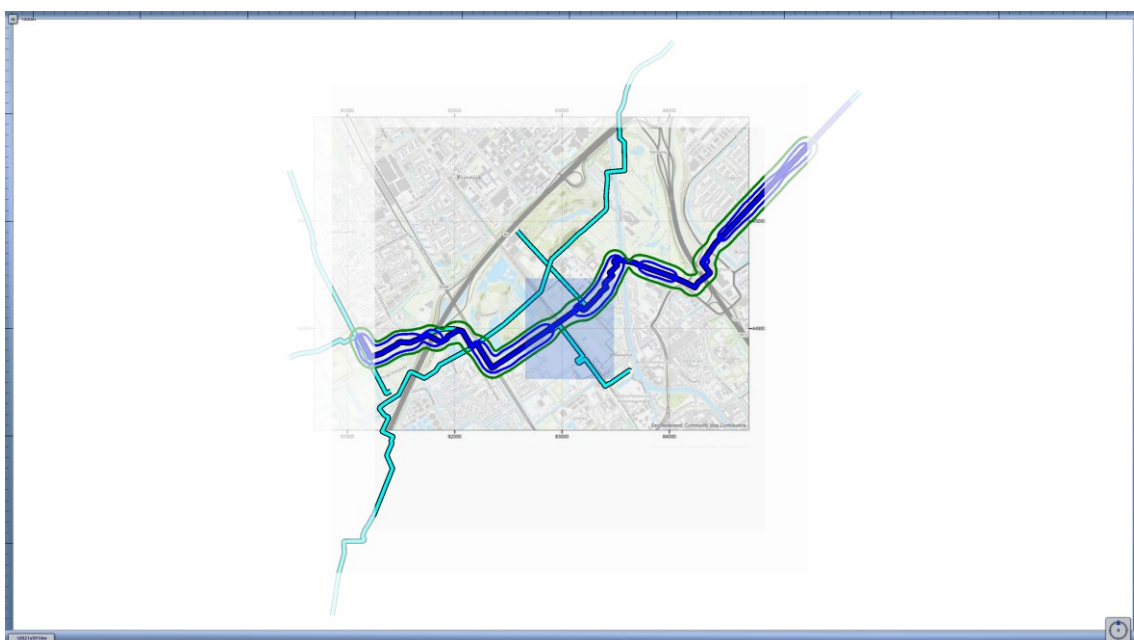
3.2 Figuur 3.2 Plaatsgebonden risico voor 7936_leiding-W-514-01-deel-1_excl verl van N.V. Nederlandse Gasunie
