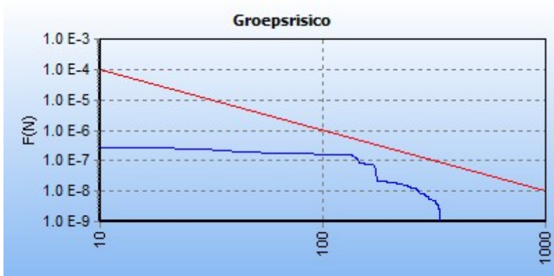
5.2 Figuur 5.2 FN curve voor 7936_leiding-W-514-01-deel-1_excl verl van N.V. Nederlandse Gasunie voor de kilometer tussen stationing 1760.00 en stationing 2760.00
