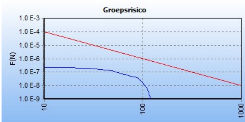
5.2 Figuur 5.2 FN curve voor 7936_leiding-W-514-01-deel-1_excl verl van N.V. Nederlandse Gasunie voor de kilometer tussen stationing 1760.00 en stationing 2760.00
