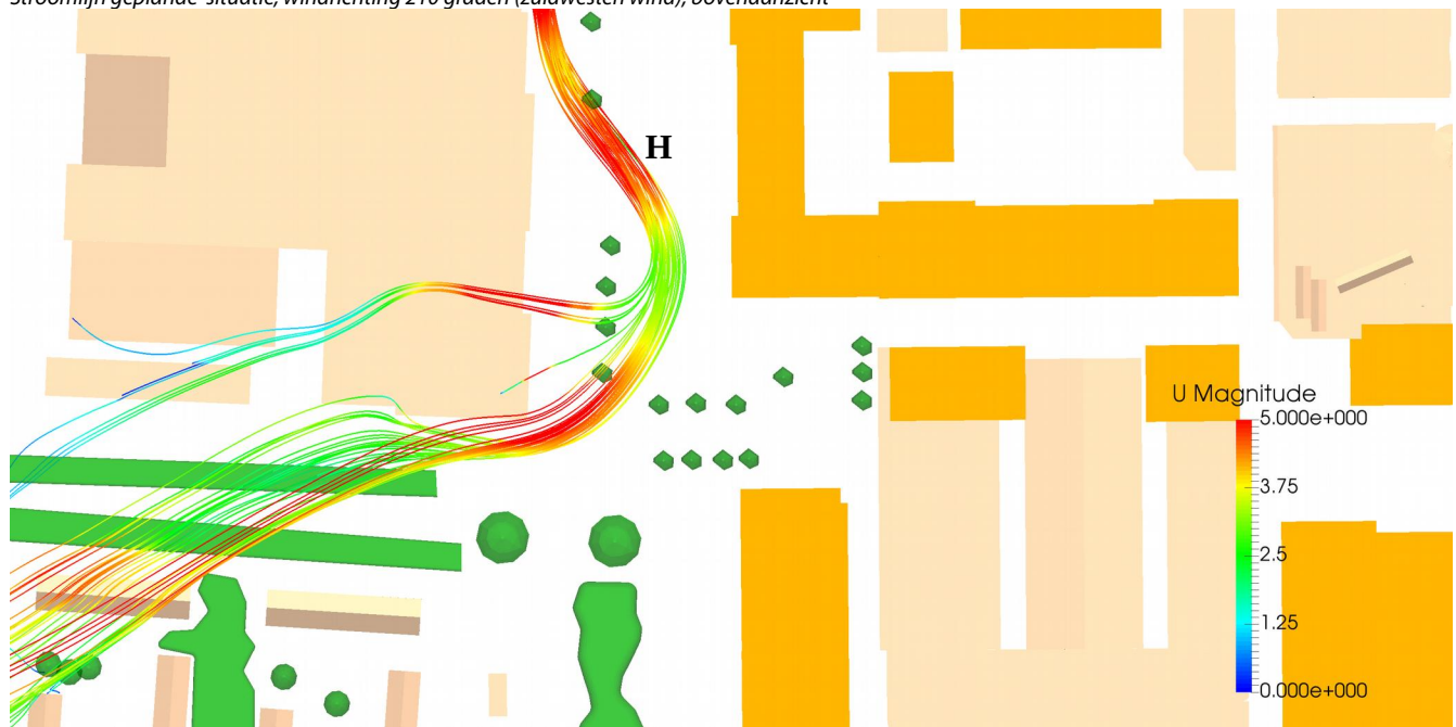
f12 Stroomlijn geplande situatie, windrichting 240 graden (zuidwesten wind), bovenaanzicht
