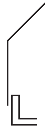
Betonnen lage plint met een opbouw van hout
