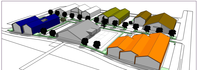
Elk pand een eigen materiaal, in langsgevel en dak doorlopend
