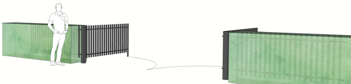
Draaihek. Hekwerk steekt niet uit boven de 1-1.2m hoge haag
