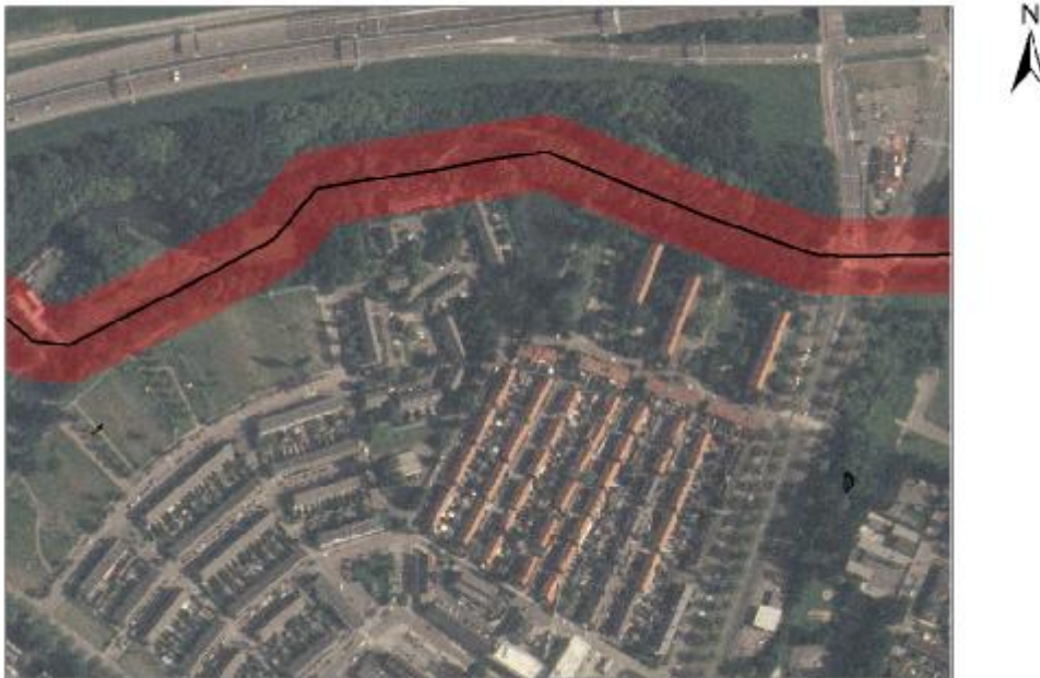
Figuur 12, bebouwingsafstand (rode contour) van de hogedruk aardgasleiding A517.
