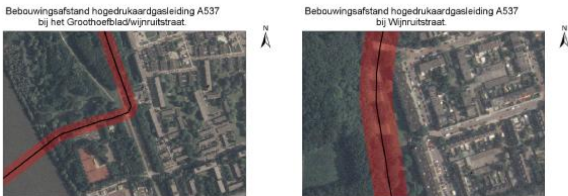
Figuur 13, bebouwingsafstand (rode contour) van de hogedruk aardgasleiding A537.
