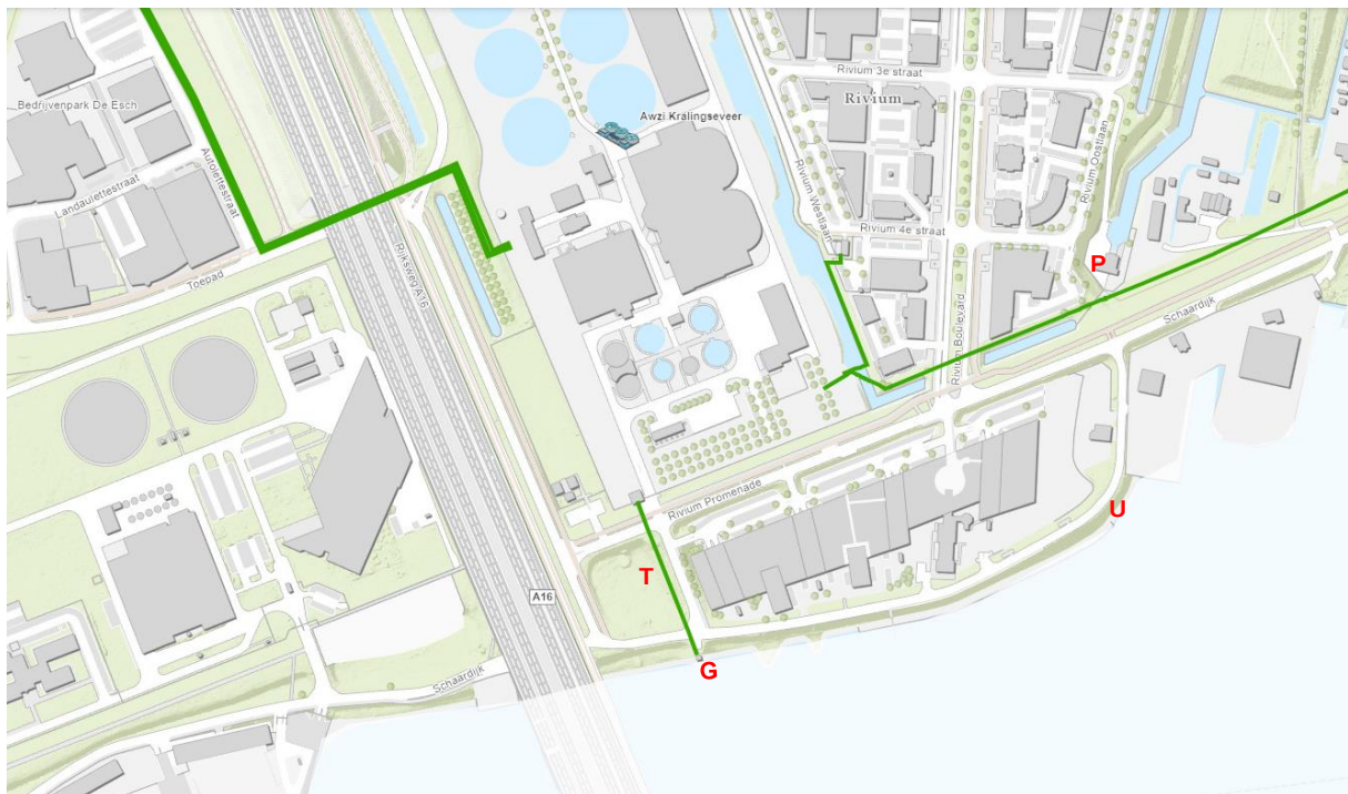
Figuur 9 Lozingspunt afvalwaterzuivering Kralingseveer, pompgemalen en lozingspunten (bron: hoogheemraadschap Krimpenerwaard, HHSK op de Kaart (schielandendekrimpenerwaard.nl) , d.d. 22-4-2022)
