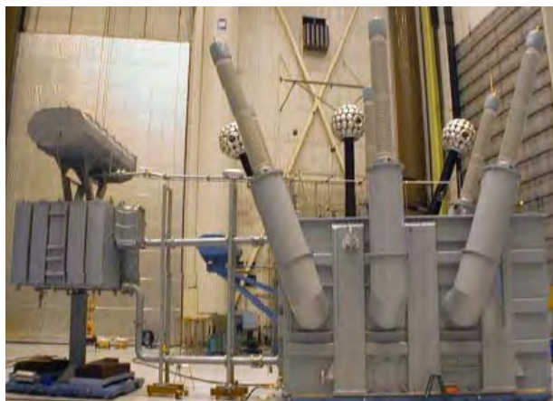
380kV-seriespoel olie geïsoleerd in het hoogspanningslaboratorium
