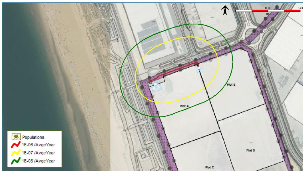
Figuur 5-2: PR-contouren ondergrondse leiding leverancier B (rode leiding). De leiding heeft geen 1E-06 PR-contour.
