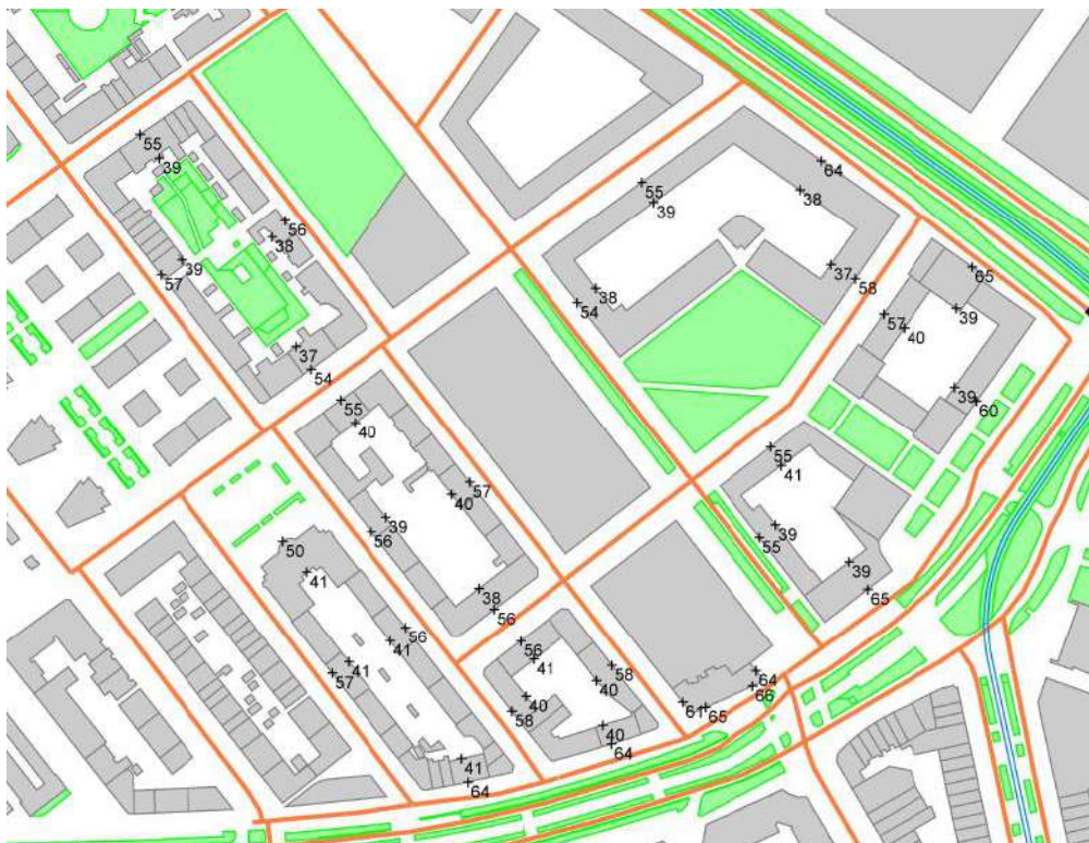
Figuur 3 Rekenresultaten wegverkeerslawaaai MER beoordeling projectgebied Tweebosbuurt
