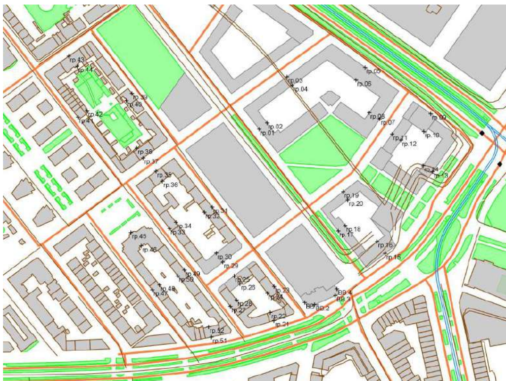
Figuur 2 Rekenmodel en rekenpunten wegverkeerslawaaï MER beoordeling projectgebied Tweebosbuurt
